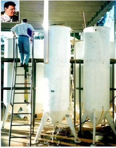
図16 ブラジルの上向流粗ろ過実験装置
