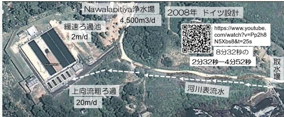
図11 濁り対策で上向流粗ろ過
