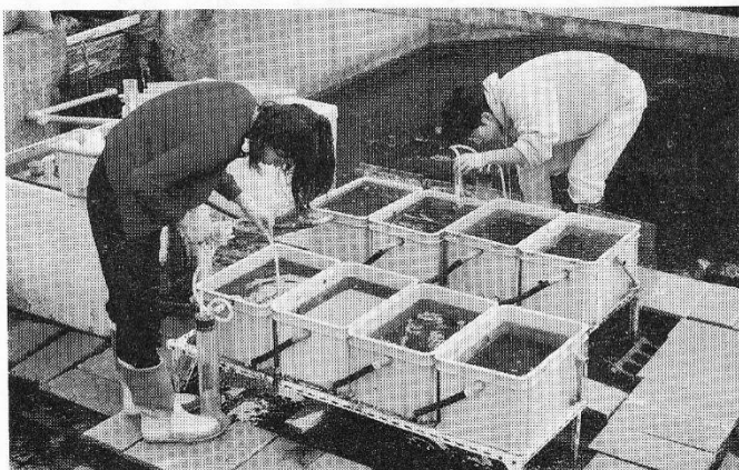
図11 小山養魚場の養魚池を借用して、河川水中の栄養塩除去実験を行った。糸状珪藻を繁殖させ、栄養塩をどの程度除去できるかの実験を行った。
