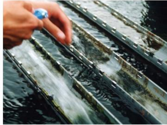
図8-2.雨樋に付着板として透明塩ビ板をクリップで固定
