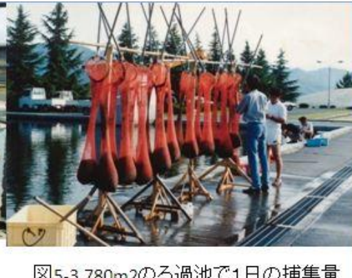
図5-3.780m2のろ過池で1日の捕集量
