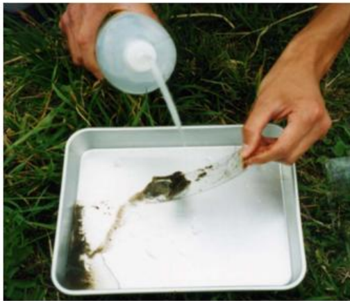
図8-3.洗瓶の水で洗い流されるのはLoose.ブラシで削り取るのはAdnate
