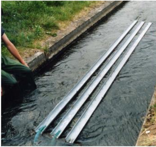
図8-1.水路にポンプで流速を変えての実験
