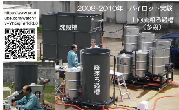
図28 上向流粗ろ過のパイロット試験
