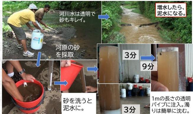
図28 河床の砂泥試験
