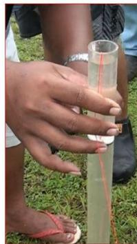
ろ過池が目詰まりすると、すぐに流入弁を全開してしまっていた。12月3日にも再び雨が降ったので、現場に行ったら流入水量調節弁は全開であった。そこで、すぐに、流入弁を絞った。沈殿池の仕組みを現場技術者に伝えるのは本当に大変というのを実感した。荒川さんは日本から長さ1メートルのクリーンメジャー（透明アクリル管の透視度計）を持参してくれていた。現場でクリーンメジャーを使って濁りと沈降時間を検証した（図23）。NTU濁度で105度の細かな濁りは、5分間で半分以下の45度になった。沈殿池の容積は小さく沈殿効果は余り期待できない
