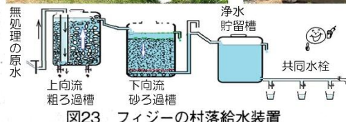
図23 フィジーの村落給水装置
