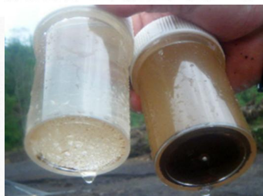
図31 沈降性が良い汚泥
