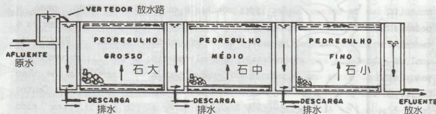
濁り水対策の前処理：礫の大きさの異なる3段の上向流礫ろ過
