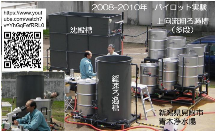
図42 上向流粗ろ過の実験
