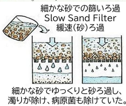
図2 緩速ろ過のイメージ
