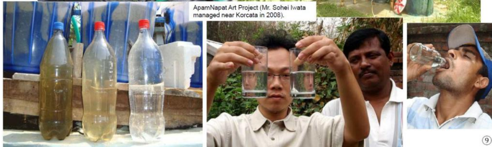
9-9 インドのコルカタで、岩田宗平さんは、腐植で褐色の地下水を、何段もの上向流粗ろ過を繰り返して、飲める水にした。難分解性の腐植も生物分解できた。
