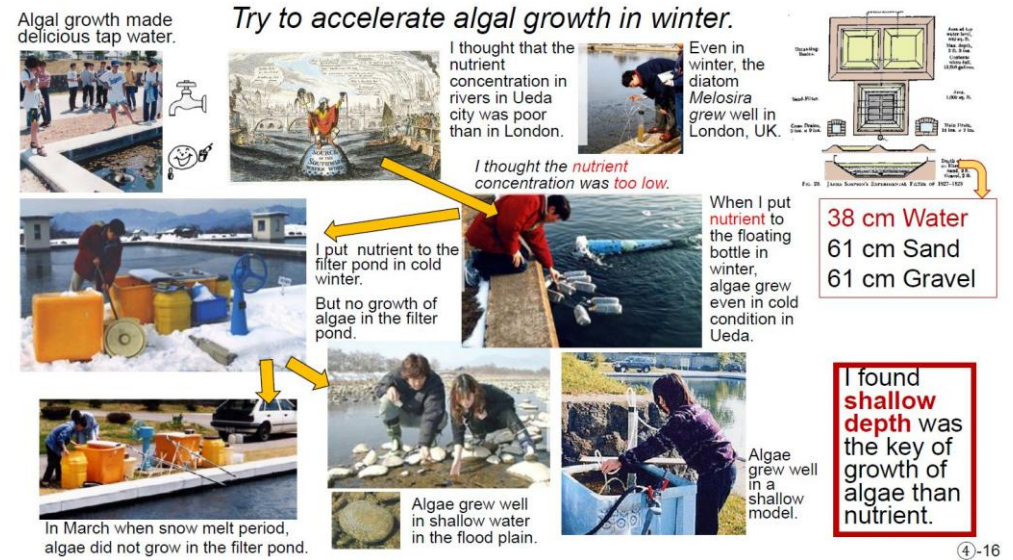
4-16 テムズでは、冬でも藻が繁殖。上田市では、厳寒期の冬に、藻が繁殖しないのは、もしかしたら栄養塩が足りないかと思い、栄養塩添加実験をした。でも繁殖しない。水深が関係していた。浅ければ厳寒期でも藻が繁殖した。
