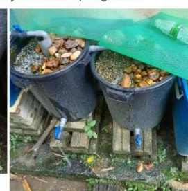
6-8 砂ろ過池、上向流粗ろ過槽に藻が繁殖。排泥をしてみた。
