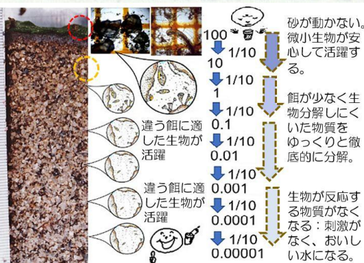
図22 細かな砂の緩速ろ過
