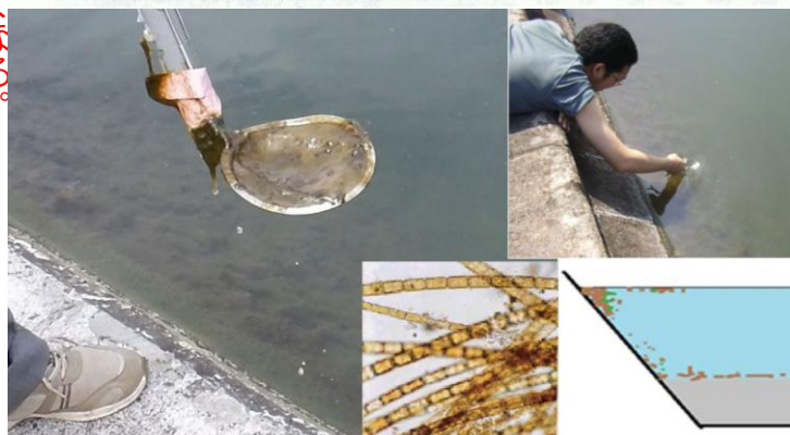
図39 斜め壁のろ過池で冬でも藻が繁殖
